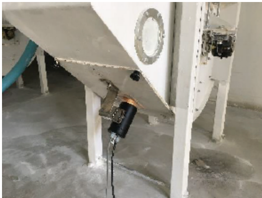
图2 小麦制粉DON 污染蔡司MCS 600 光谱仪OMK500-H/NIR 探头在线监测
